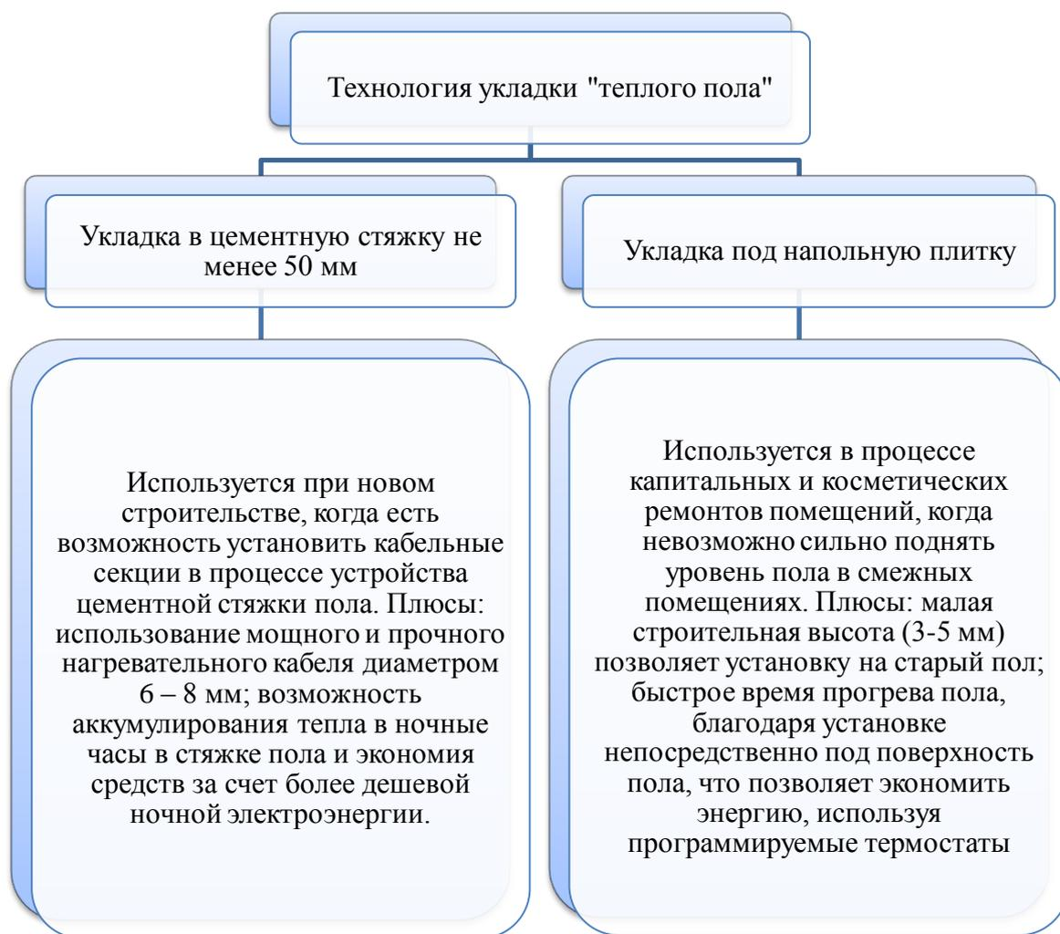
Рис. 4. Основные технологии укладки «теплого пола»
