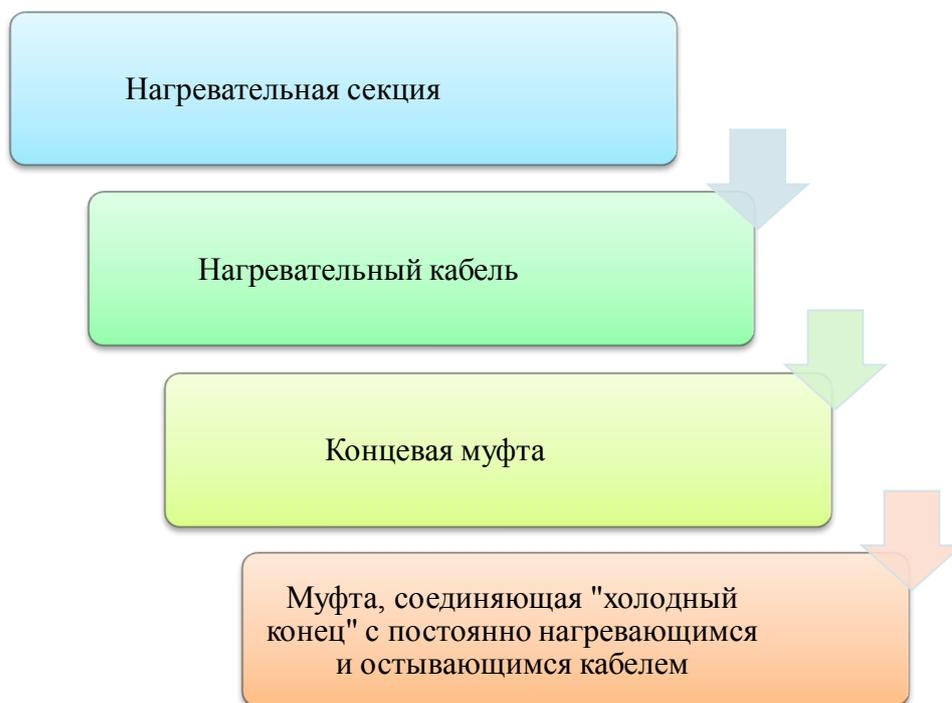
Рис. 3. Элементы, входящие в нагревательную секцию или нагревательный мат
